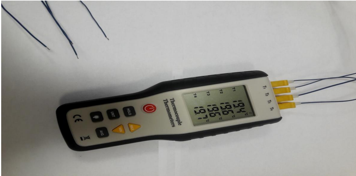
Рис 1 – Чотирьох-каналний К – типу цифровий термометр
