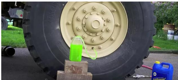
Рис. 3. Рідинне балансування коліс великих вантажних автомобілей
