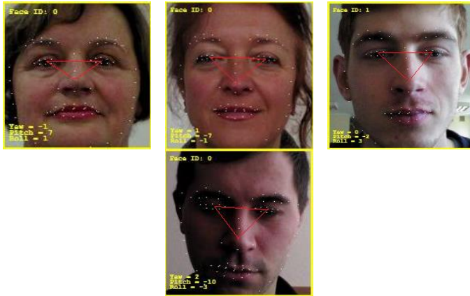
Рисунок 5 – Відображення точок обличчя для різних форм ключових зон обличчя та «Трикутник» основних точок обличчя
