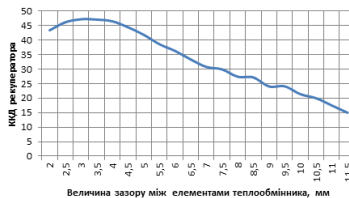
Рис. 2 – Залежність ККД теплообмінника від величини зазору між пластинами
