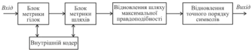
Рисунок 3 – Декодер згорткових кодів за алгоритмом Вітербі
