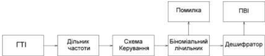
Рисунок 1 - Структурна схема завадостійкого біноміального таймера
