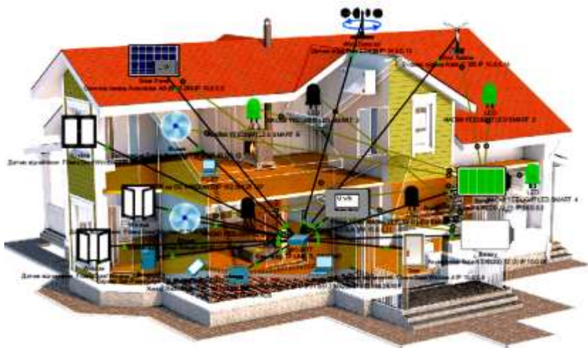
Рисунок 3- Функціональна схема розміщення обладнання мережі
