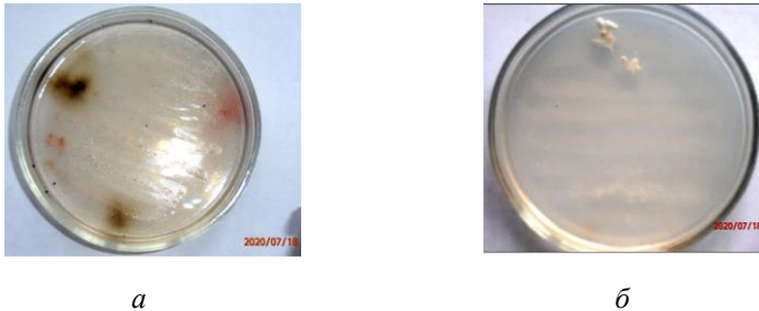
Рис. 4. Фотографії зразків росту колоній бактерій: а – контрольний зразок; б – після оброблення гідрокавітацій (залишилися колонія одного виду бактерій)
