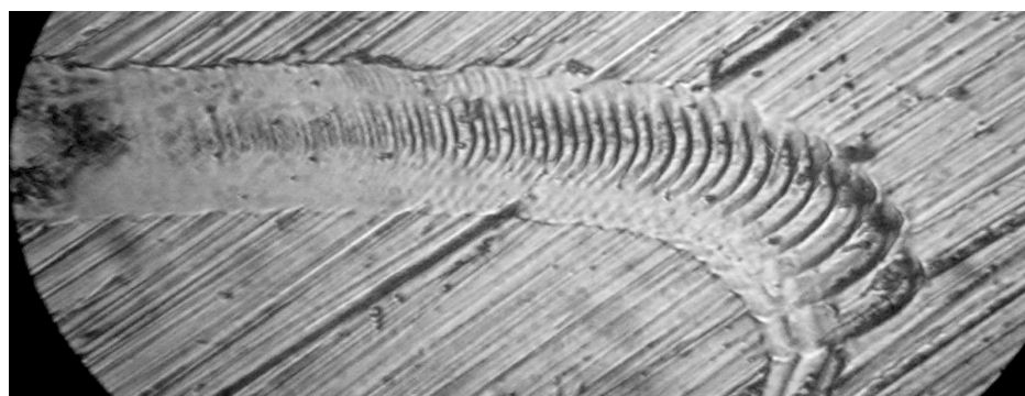
Рис. 4. Процеси автоматичного встановлення двох поверхонь в умовах вібраційного тангенціального навантаження. Показані границі плями контакту та рух окремої мікро нерівності
