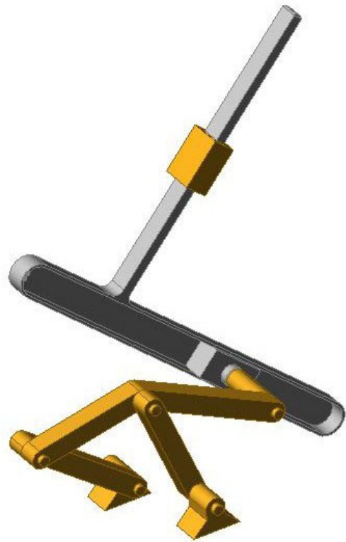
Рис. 2. Комп'ютерна модель шестиланкового важільного механізму із зупинкою вихідної ланки
