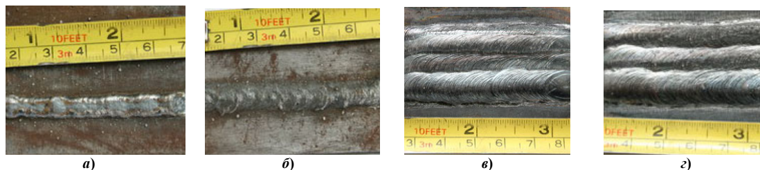
Рис. 3. Зовнішній вигляд валиків, напавлених за оптимальними режимами: а, б – дротом із сталей відповідно марок 08Г2С-О і 08Г2С із захистом зони напавлення вуглекислим газом; в, г – дротом із сталей відповідно марок 08Г2С-О і 08Г2С з захистом зони напавлення флюсом
