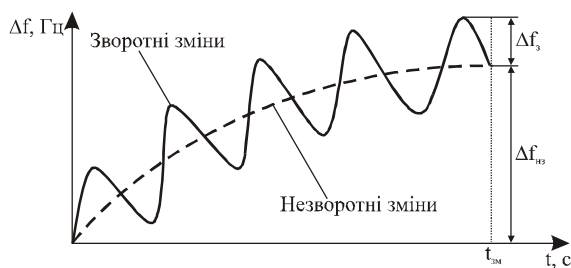
Рис. 2. Зміни частоти КР під дією вібрації
