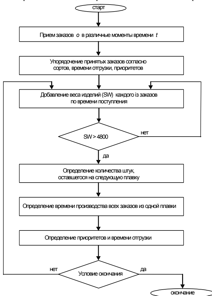
Рис. 2. Алгоритм распределения заказов заполнения печи одним сортом чугуна
