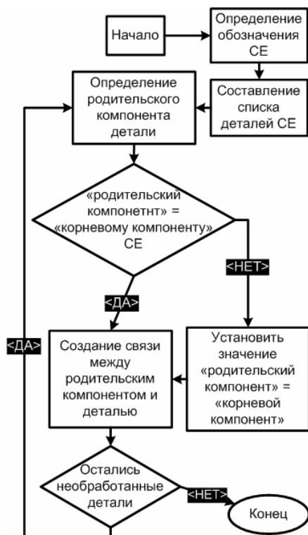
Рис. 11. Алгоритм обработки структуры сборочной единицы.
