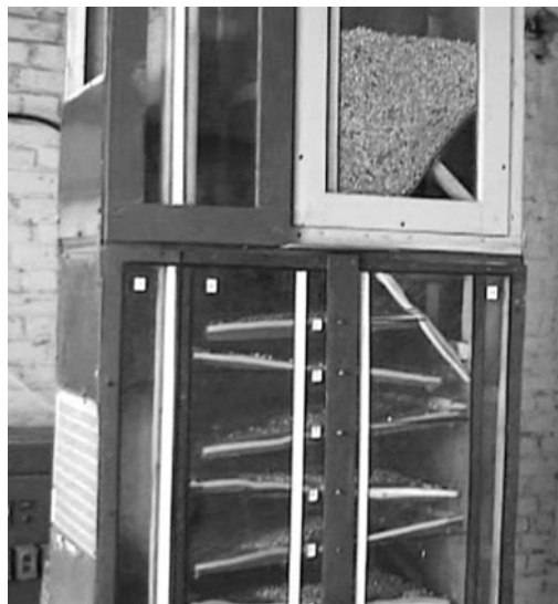
Рис. 1. Зовнішній вигляд експериментальної ЗСУ касетного типу з киплячим шаром
