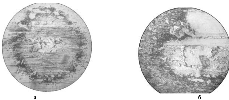
Рис. 1. Руйнування сталі ХН78Т в умовах змішаного фретинг-контакту. а – нормальне навантаження, P_n = 30 \text{ Н} , б - P_n = 75 \text{ Н} , кількість циклів N = 2,15 \cdot 10^6
