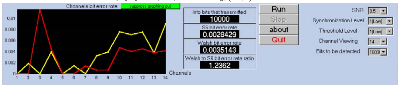
Рис. 14. Результати імітаційного моделювання 14-канальної CDMA-системи з системами ОБП \{\text{rom}_6(r, \theta)\}_{r=0}^{13} і \{\text{wal}(w, \theta)\}_{w=0}^{13} у програмному модулі c14sim, де c_{ber}(0.5, 1) = 1.2362
