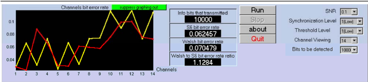
Рис. 10. Результати імітаційного моделювання 14-канальної CDMA-системи з системами ОБП \{\text{rom}_6(r, \theta)\}_{r=0}^{13} і \{\text{wal}(w, \theta)\}_{w=0}^{13} у програмному модулі c14sim, де c_{ber}(0.1, 1) = 1.1284
