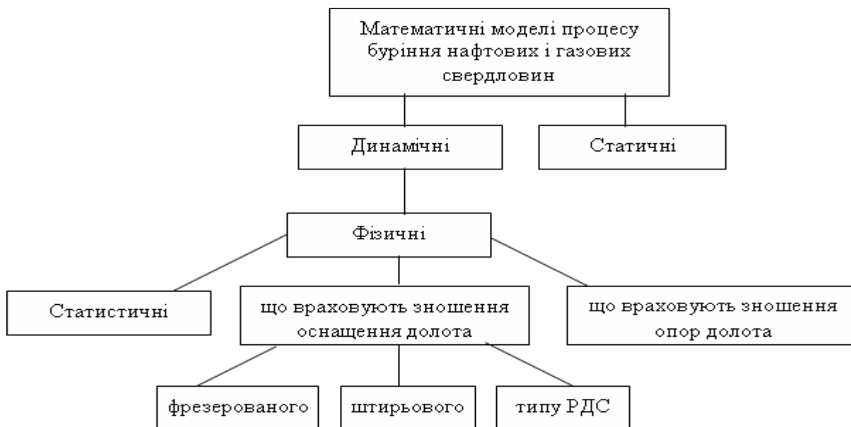
Рис. 1. Класифікація математичних моделей технологічного процесу буріння нафтових і газових свердловин
