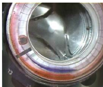
Рис. 5. Циркуляційний рух рідини в камері АБП
