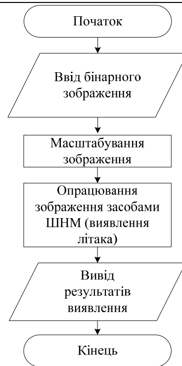
Рис. 5. Граф-схема алгоритму виявлення літака на бінарному зображенні
