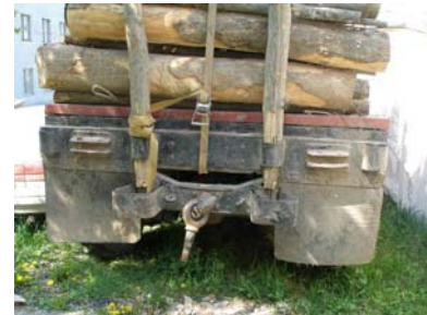
Рис. 5. Вигляд тягово – зчіпного пристрою автомобіля ЗІЛ-131 д.н. 77-88 ХМП
