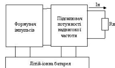
Рис. 2 Типова структурна схема генератора зондуєчих імпульсів надширококутвих мобільних радіолокаторів
