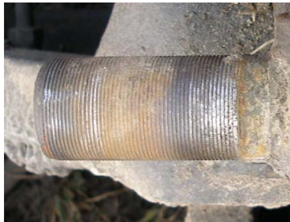
Рис. 4. Детальний вигляд пошкодження різьбової частини наконечника лівої штанги передньої підвіски автобуса «Ікарус» д.н. 002-57МС
