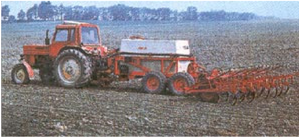
Рис. 2. ПЖУ-2,5 (підживлювач рідкими добривами)
