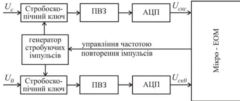
Рис. 2. Спрощена структурна схема перетворювача частоти (ПВЗ – пристрій вибірки-зберігання; АЦП – аналого-цифровий перетворювач)
