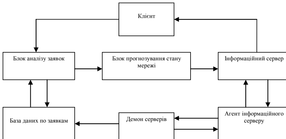
Рис. 3. Механізм роботи блоку прогнозування стану мережі
