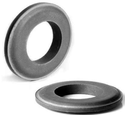
Рис. 7. Вигляд твердосплавних роликів для ЕМО після спікання
