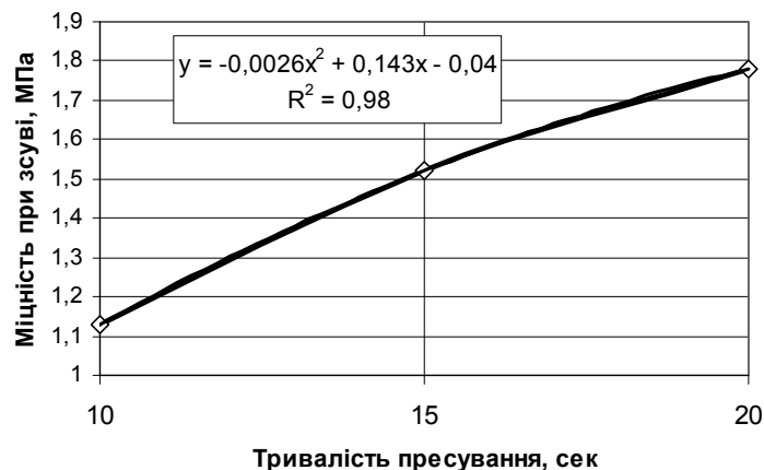
Рис. 3. Залежність міцності при зсуві від тривалості пресування клейової плівки ( t_{\text{пласт}} = 90\text{ }^{\circ}\text{C} )
