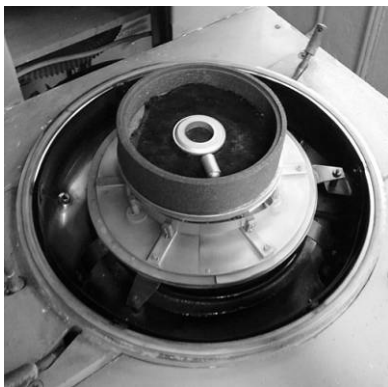
Рис. 6. Розташування ролика у графітовому контейнері
