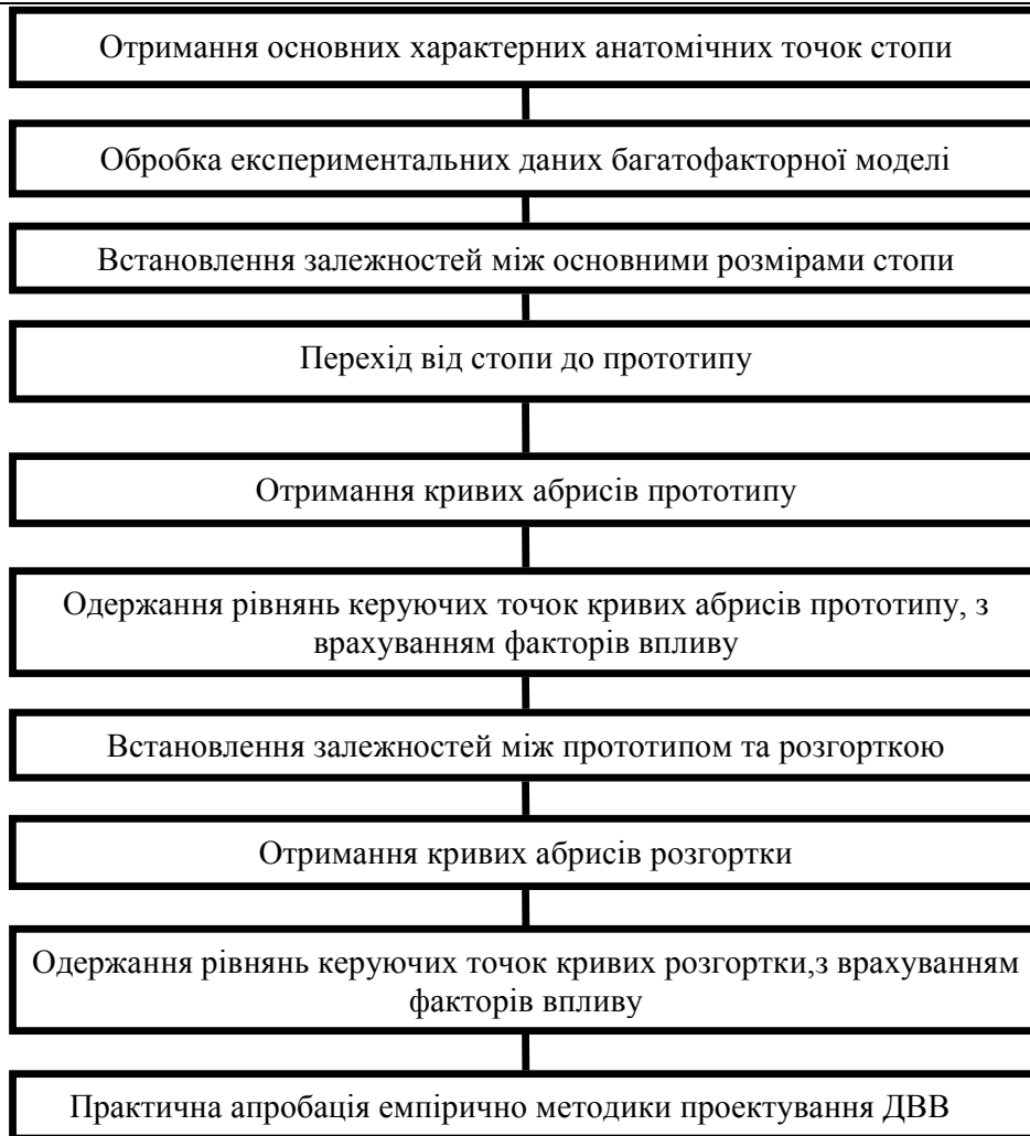
Рис. 10. Розгорнута схема алгоритму застосування емпіричної методики ДВВ
