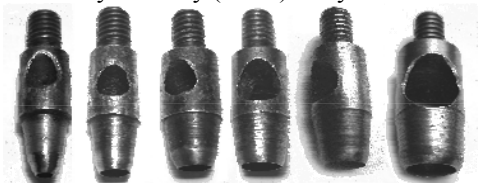
Рис.3. Пробійники для вирубання отвору в матеріалі
