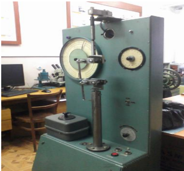
Рис. 1. Модифікована розривна машина РТ-250М.
