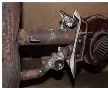
Рис. 6. Вентилятор і засоби регулювання
