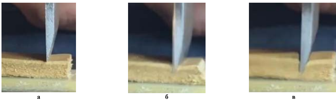
Рис. 9. Етапи занурення різачка в натуральну шкіру низу взуття: а – стискання; б – різання; в – зона недеформованого матеріалу
