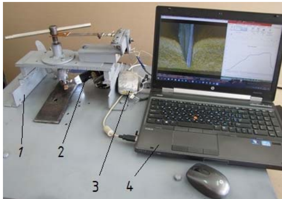
Рис. 1. Установка для дослідження операції вирубування взуттєвих матеріалів в статичному режимі
