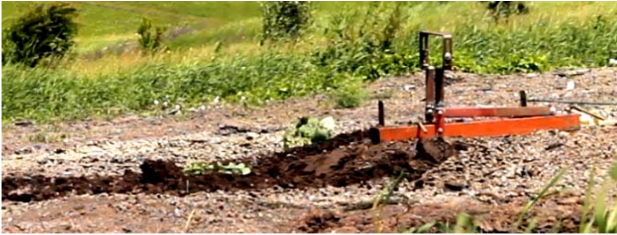
Рис. 15. Вид неушкодженого пристрою для дистанційного приведення в дію ручних осколочних гранат та їх підричників після вибуху
