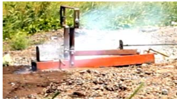
Рис. 12. Момент ініціювання сповільнювача підричника гранати
