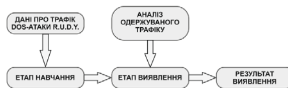
Рис. 1. Укрупнена схема функціонування методу виявлення кібератаки типу R.U.D.Y. на основі використання алгоритму визначення самоподібності трафіку
