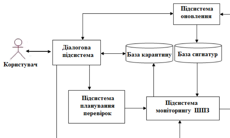
Рис. 2. Структура системи захисту комп'ютерної інформації
